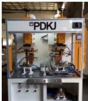
汽车副车架自动焊接专机
